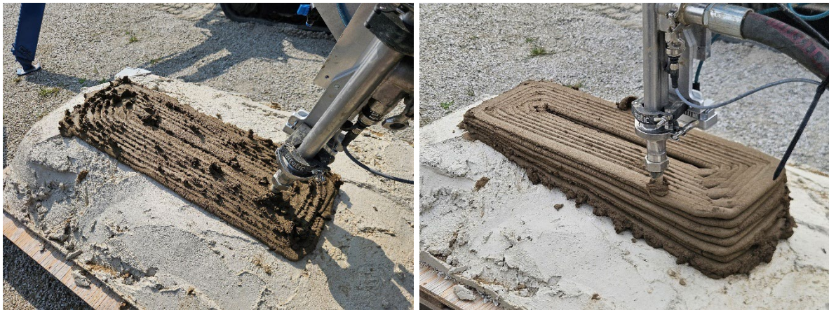
Figur 8: Utskrift på oregelbunden yta med variabel lagerhöjd för att uppnå jämna lager.
